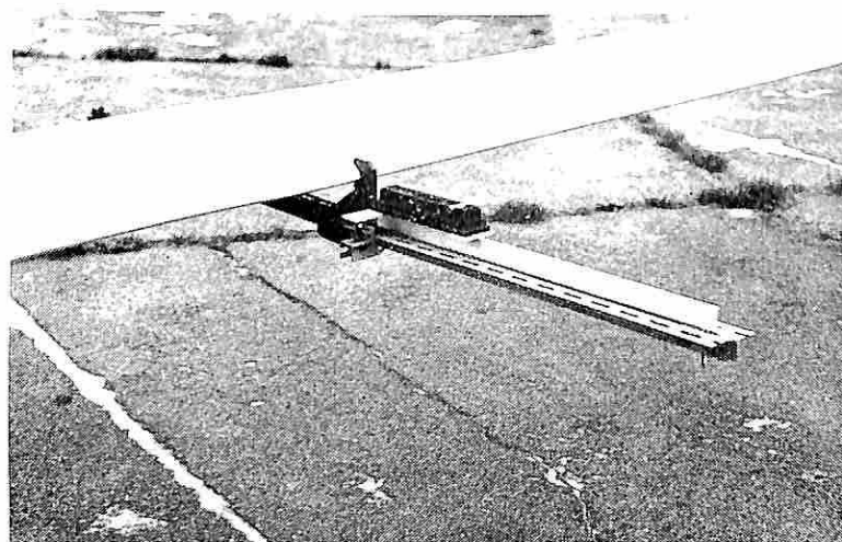
Apparecchio misuratore di simmetria di incidenza alare
