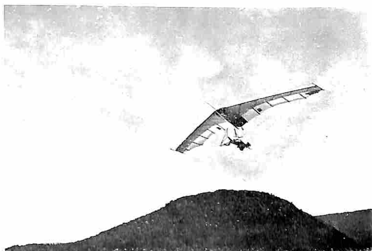
Un'ala rigida ad «altissima» efficienza (circa 10) inglese, HIWAY. Ha perso il campionato per penalizzazione in atterraggio.
