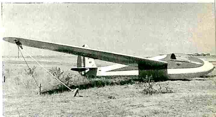
Lo « Schweizer » S.G.S. 1-23 realizzato completamente in metallo (Stati Uniti d'America)
