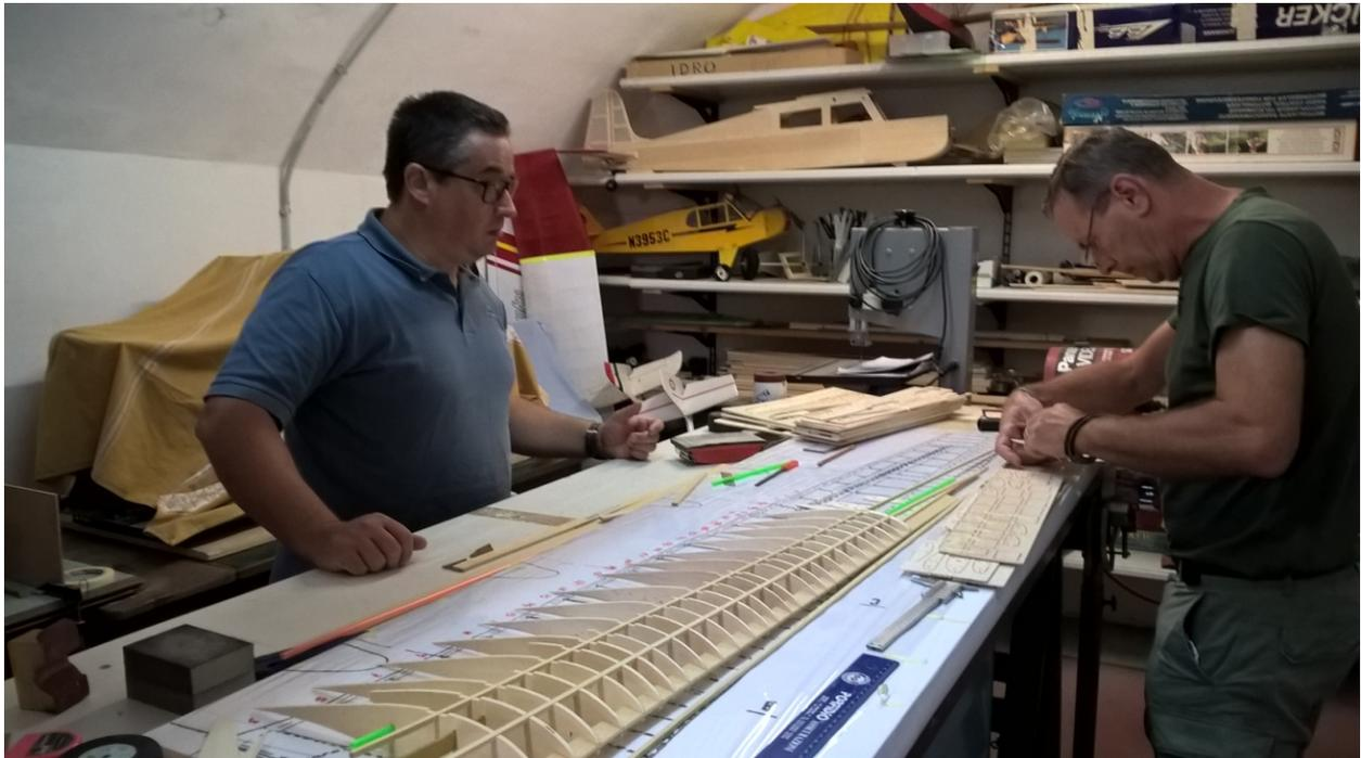
*Enrico a sinistra e Danilo in fase di assemblaggio dell'ala del Ka-2*
