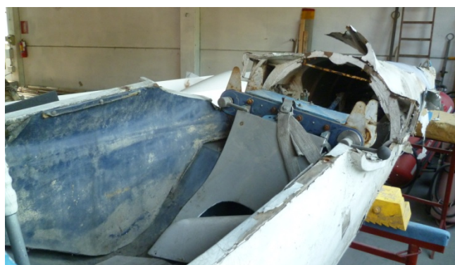
Particolare della zona attacchi alari
