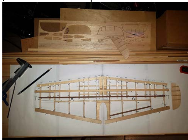
Lo stabilizzatore in fase di allestimento
