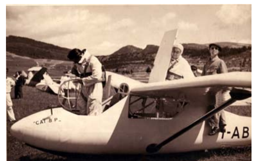
Il Cat-28 B.P. si appresta al decollo dall'aeroporto di Asiago. Da notare la particolarità per l'ingresso al secondo posto di pilotaggio utilizzata anche per l'aliante "Canguro"
