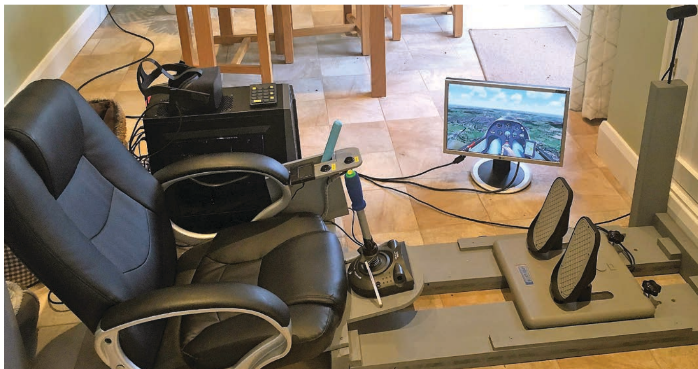
Una postazione casalinga con joystick "force feedback" adattato a una barra, e il visore 3D Oculus. La torretta a destra è invece in sensore TrackIR per l'uso di un grande display piatto
