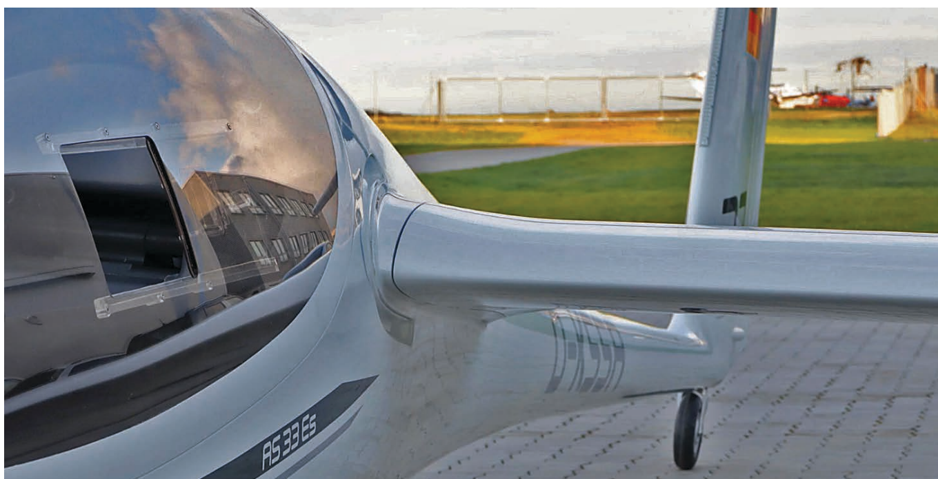
L'ala ha uno spessore relativo molto contenuto, anche nella porzione che si innesta nella fusoliera. I nettamoscerini sono integrati nella linea dell'abitacolo
