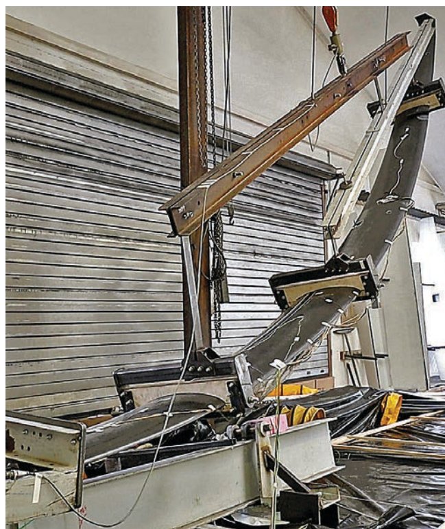
La prova di carico per le certificazioni EASA
