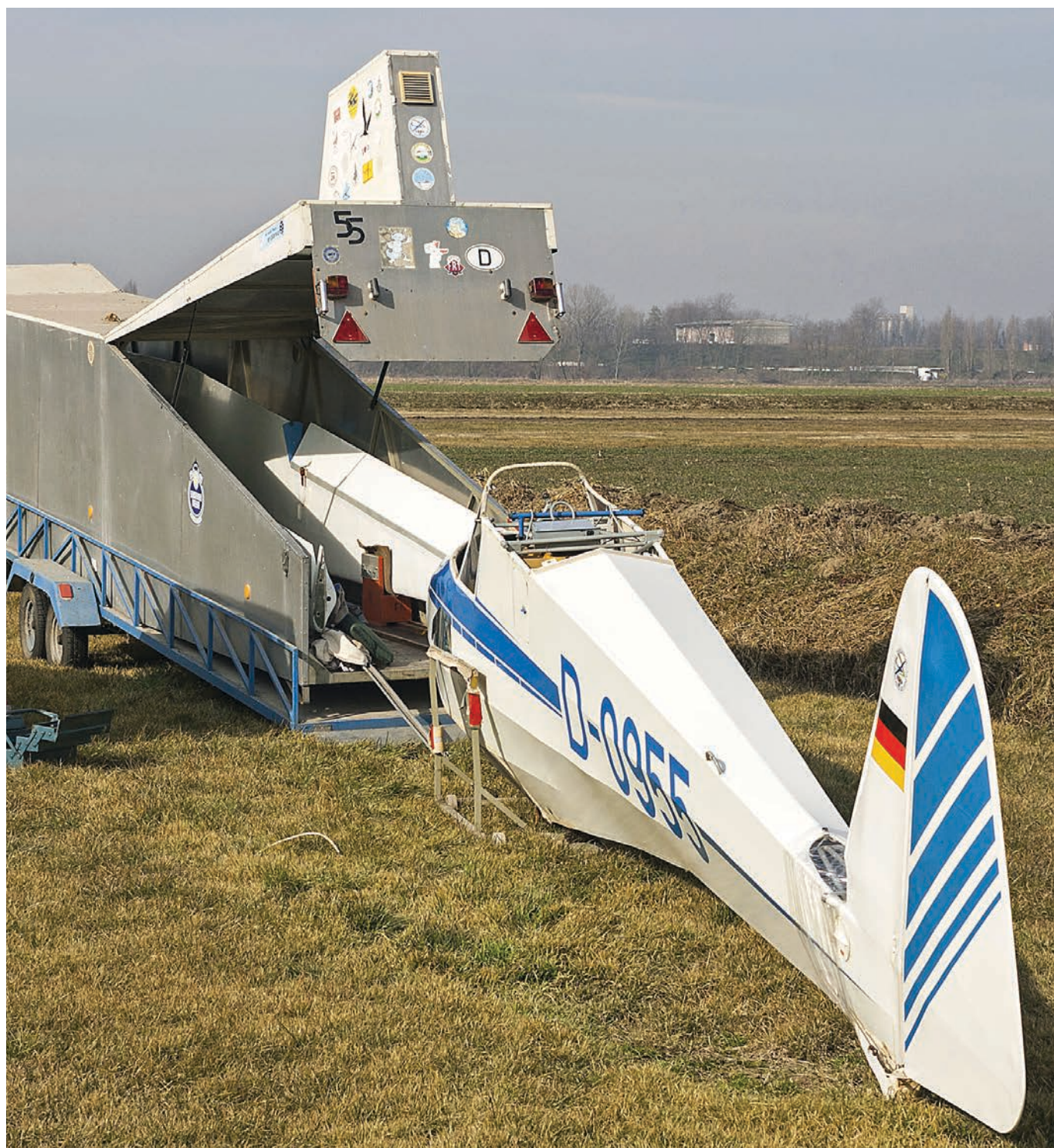
Il rimorchio tedesco è appoggiato su un pianale italiano. Molto lavoro di trapano, silicone e lastre di alluminio, poi sugli accessori elettrici
