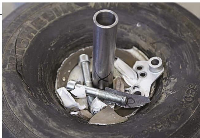
La ruota ha ceduto sotto il carico dell'impatto. Illesi i piloti e anche l'aliante
