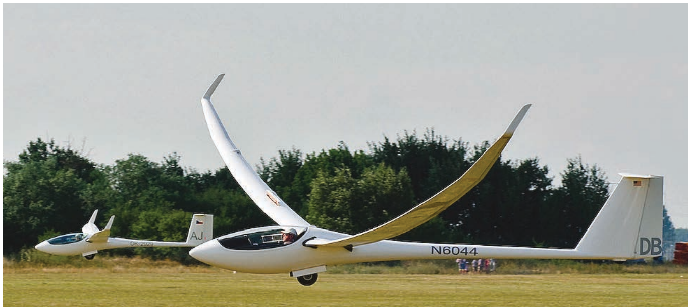
Spettacolo: l'esemplare unico Concordia di Dick Butler, 28 metri senza motore e fino a 62 kg/m 2 di carico alare. In secondo piano, il LAK 17 da 21 metri
