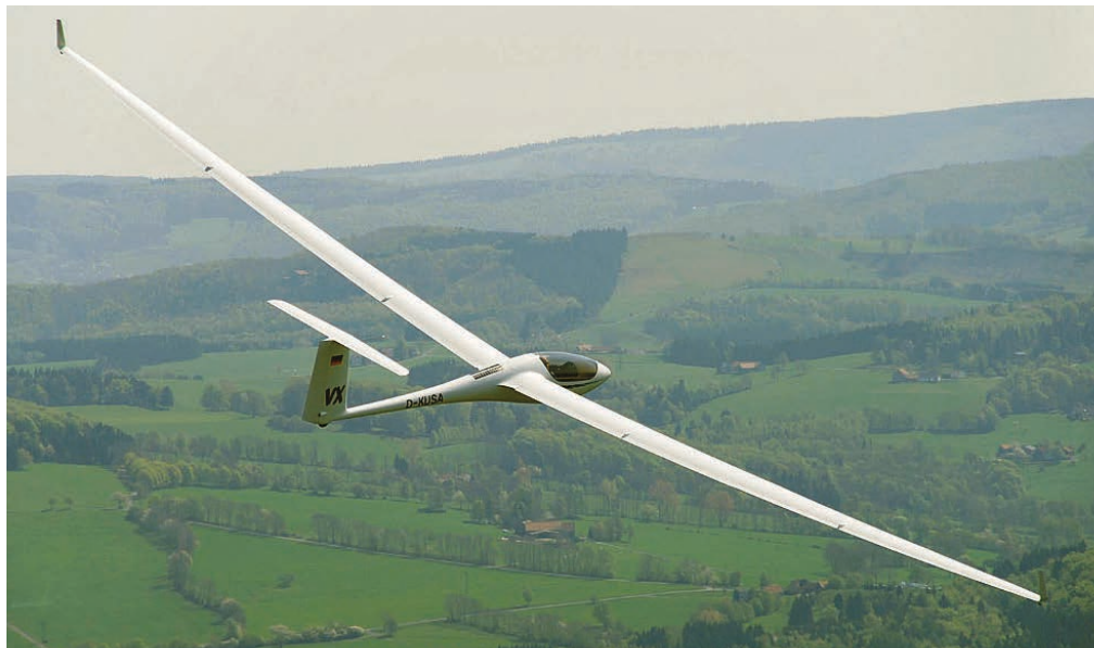
L'ASH 31 ha ottimo successo commerciale, con motore Wankel e decollo autonomo
