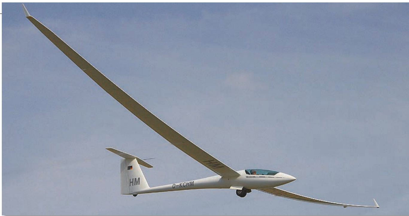
Caratteristico il carrello di atterraggio con due ruote gemellate. Punto debole di due generazioni della Open Class: la torsione del cassone alare verso le estremità, durante le flessioni dovute ai carichi dinamici
