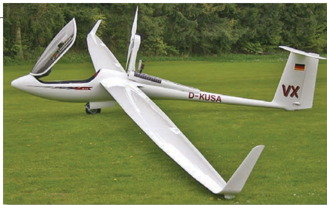
L'ASH 31 ha ottimo successo commerciale, con motore Wankel e decollo autonomo
