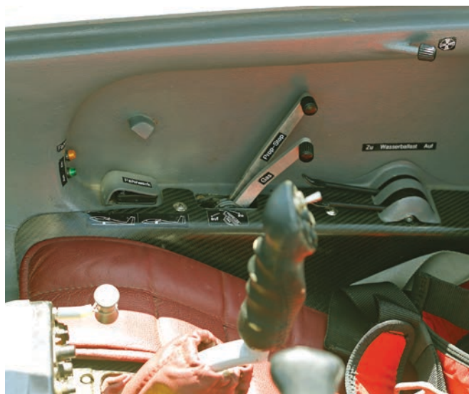
I comandi del carrello (elettrico), del motore (gas e fermo dell'elica) e della zavorra
