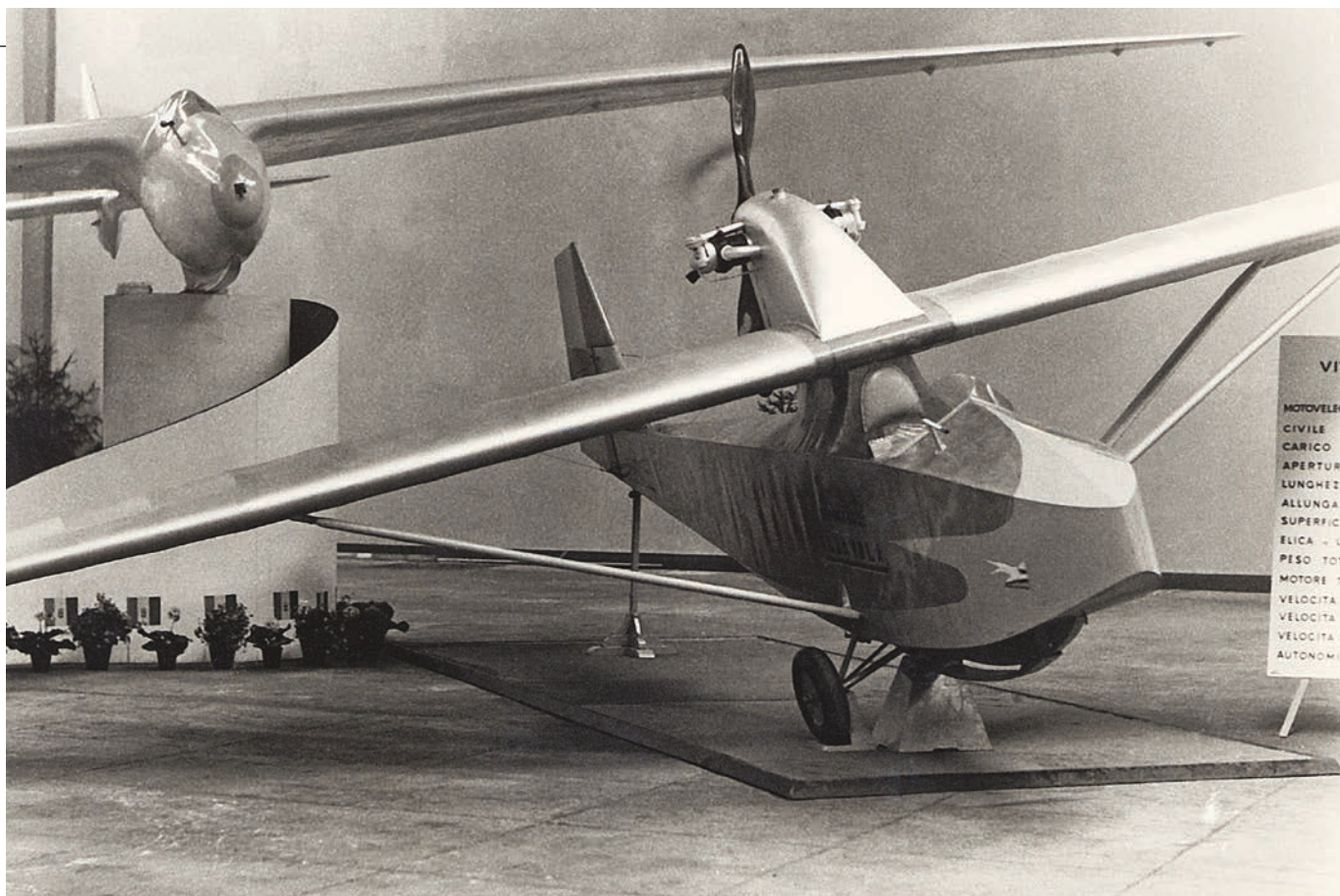
Motoaliante BS22 Alzavola, concepito per una realizzazione a basso costo. Vi erano installati motori da 18 a 25 cavalli
