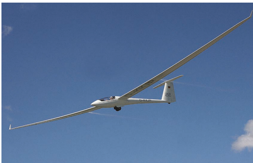
Un "22" in atterraggio, mentre scarica l'acqua tramite elettrovalvole
