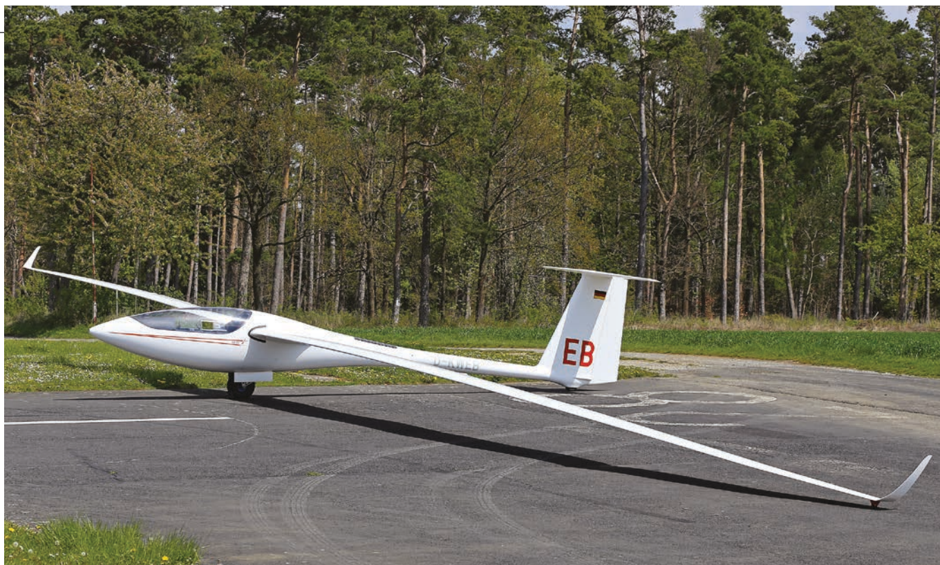
Il Binder EB29 monoposto, qui nella versione R: un'ala tutta nuova e 850 kg MTOW per le gare (la versione originale ha terminali intercambiabili per 25, 28,3 e 29,3 metri d'apertura (massa max. 900 kg nei voli individuali))
