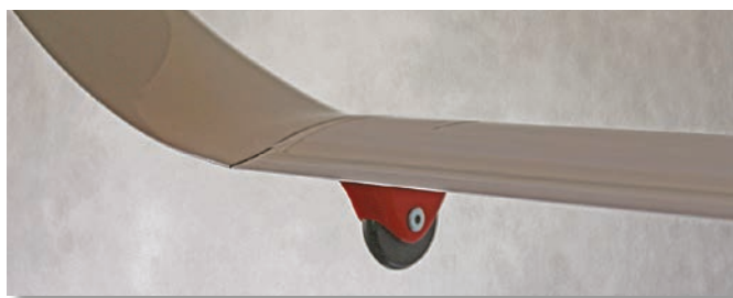
Il ruotino riduce il rischio di danneggiare le lunghe ali in caso di contatto col suolo in decollo/atterraggio
