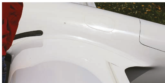
L'ala Racing ha corda ridotta. Il raccordo permette di installarla sulle esistenti fusoliere di EB29
