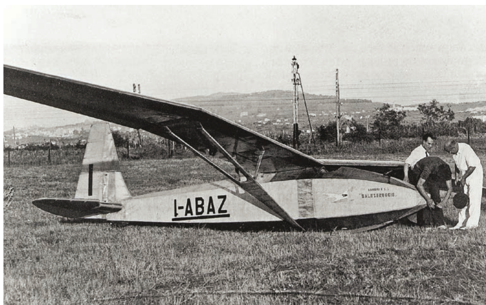
Il BS2 Balestruccio disegnato da Silva per la ricerca di record, con flap centrali e alettoni differenziali. Un solo esemplare costruito
