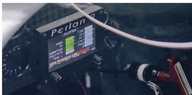
Lo strumento dedicato ai parametri di flutter
