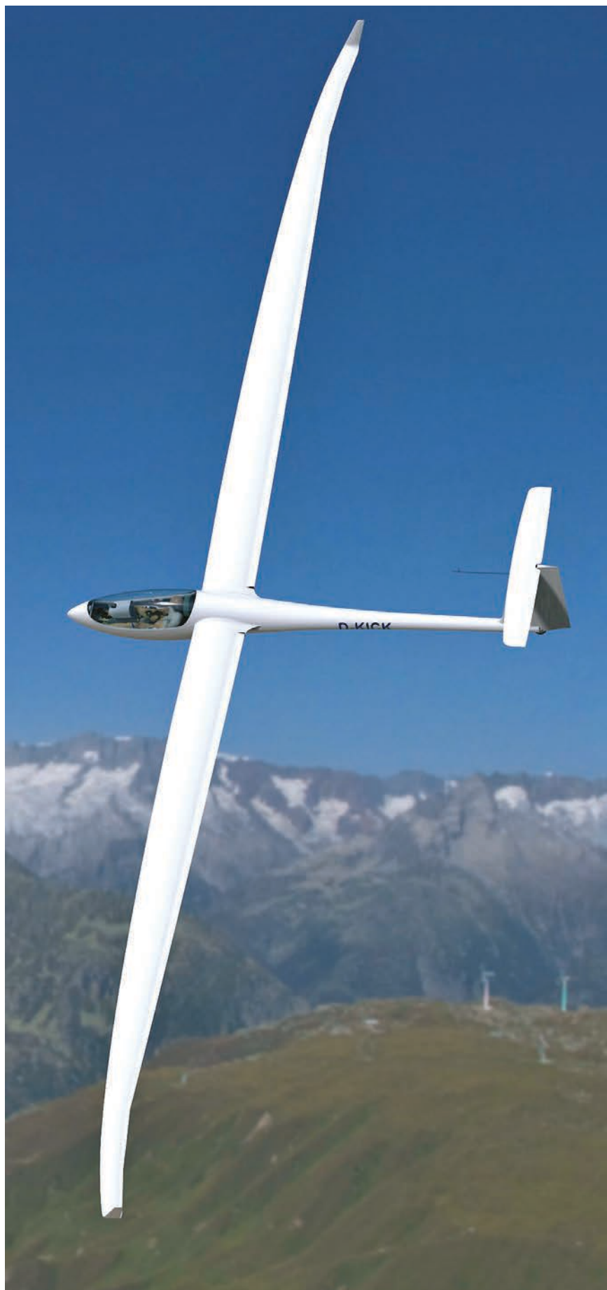
I terminali alari hanno freccia positiva per migliorare il comportamento in spirale
