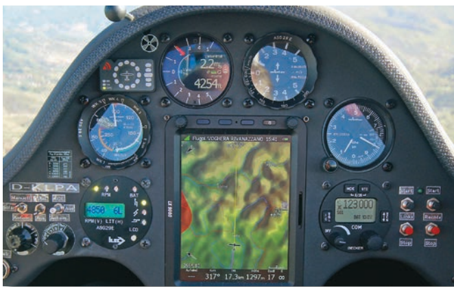
Gli strumenti di navigazione, del motore, e il selettore di batterie e ricarica solare
