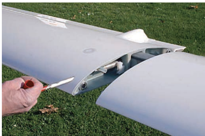
L'innesto dei terminali alari con perno nel bordo d'attacco
