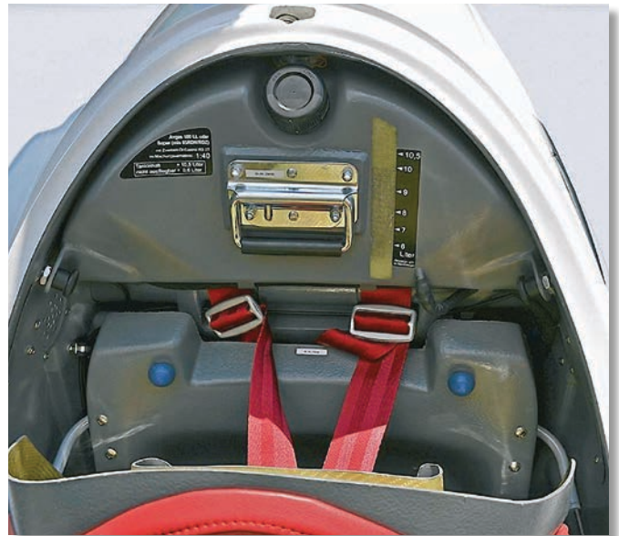
Il serbatoio benzina trova posto dietro la testa del pilota, azzerando il vano portabagagli
