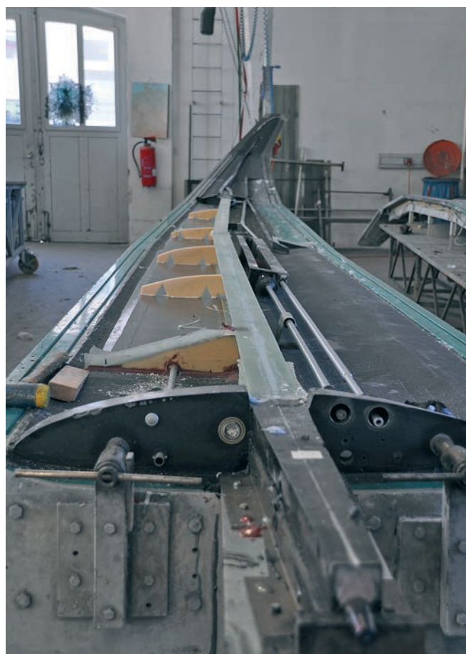
L'ala di un Arcus in fase di allestimento sullo scalo di produzione nel reparto ali
