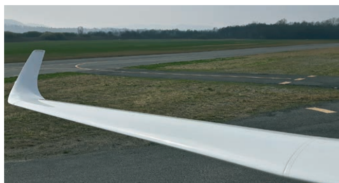
Il terminale che ha permesso di allungare l'ala a 25 m
