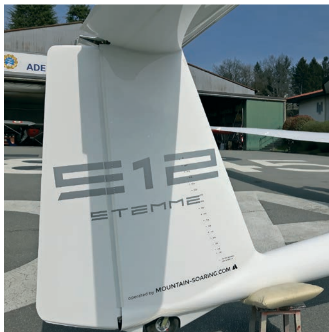
La deriva contiene finalmente un ampio serbatoio di zavorra
