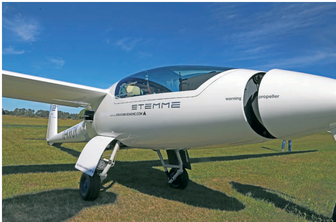
Il cono di prua avanza per esporre l'elica con una semplice azione diretta sulla manopola alla base del pannello strumenti
