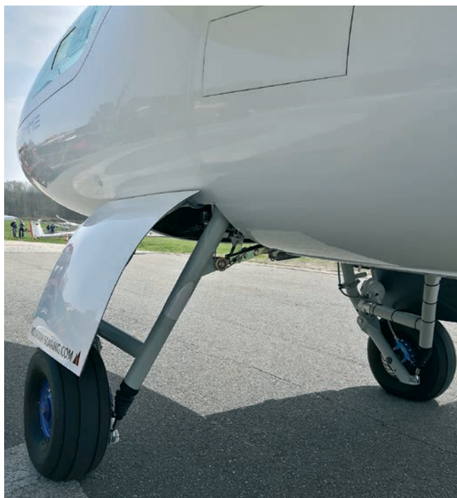
La traccia del carrello è stata allargata di 15 cm
