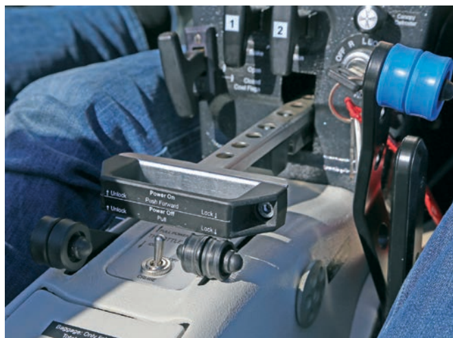
La maniglia del cono di prua copre (giustamente) i comandi del motore quando retratta
