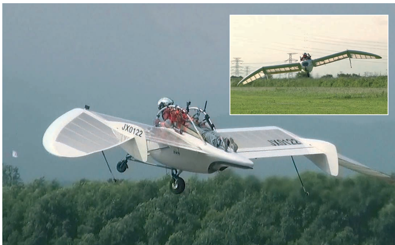
L'OpenSky M-02j durante il decollo autonomo a reazione. Nel riquadro: stabilità marginale e forte sensibilità all'effetto suolo
