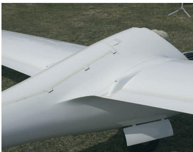
I coperchi del vano batterie sono quelli originariamente predisposti per il motore a due tempi
