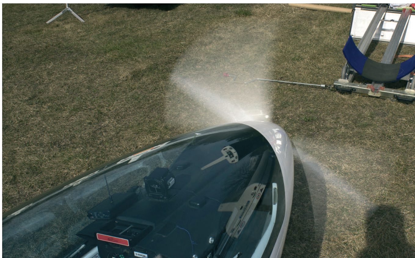
L'elica si apre per l'azione centrifuga della rotazione e inizia a fornire una trazione
