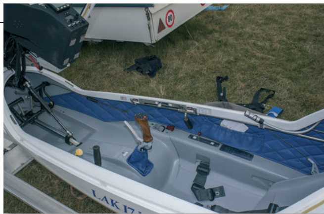
Il pannello strumenti si alza insieme alla capottina per un facile ingresso
