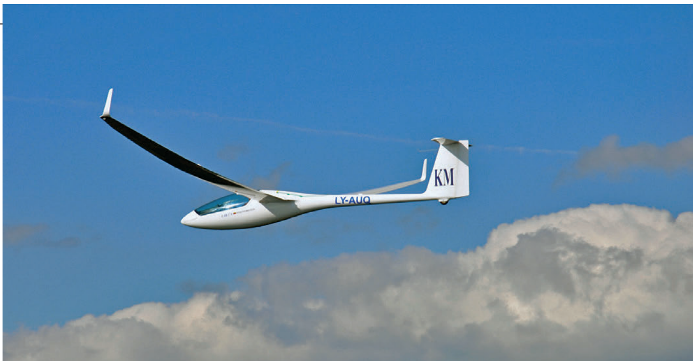
Il LAK 17b si riconosce per le winglet molto alte, quasi perpendicolari al piano alare (dal sito LAK)
