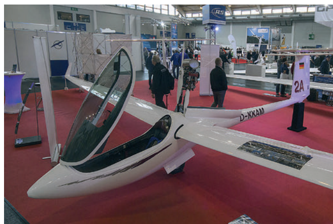
La versione ES dell’ASG29 ha avviamento elettrico e i “garage” per nettamoscerini
