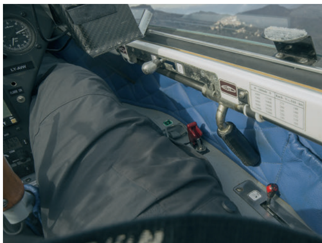
A destra, il comando del carrello offre un sicuro bloccaggio
