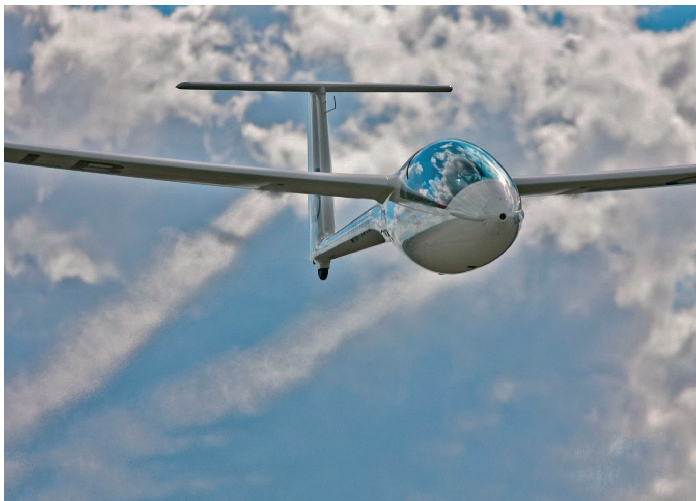
La fusoliera del LAK ha diametro contenuto. L'abitacolo offre il giusto compromesso tra spazio, comfort e ridotta sezione frontale. L'elica ripiegata si nota appena (foto dal sito LAK)
