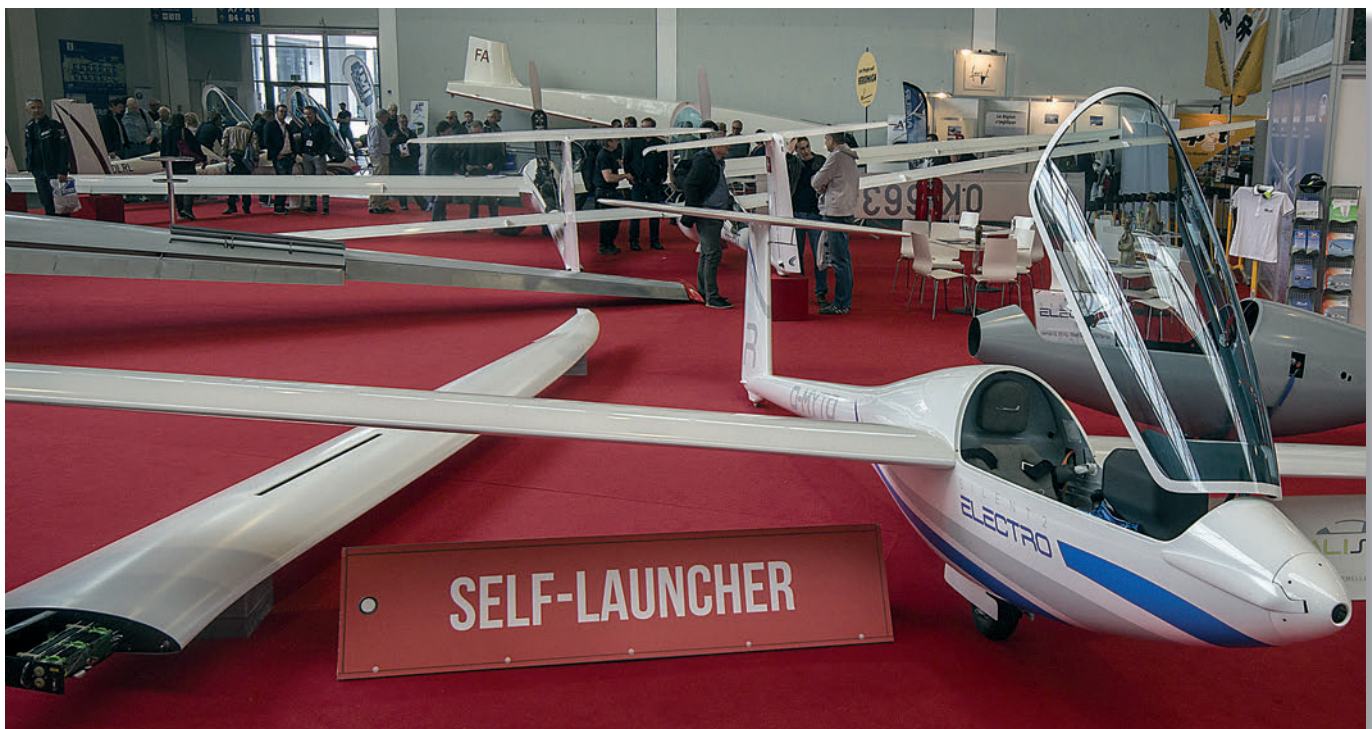
Batterie anche nelle ali per moltiplicare l'autonomia di crociera del Silent 2 Electro
