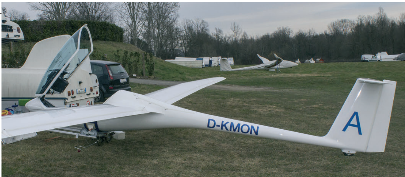
Questo LAK 17b è un esemplare del 2009 ed ancora in ottimo stato. Il comando degli alettoni agisce solo sulla porzione esterna, mentre il flap è a tutta apertura
