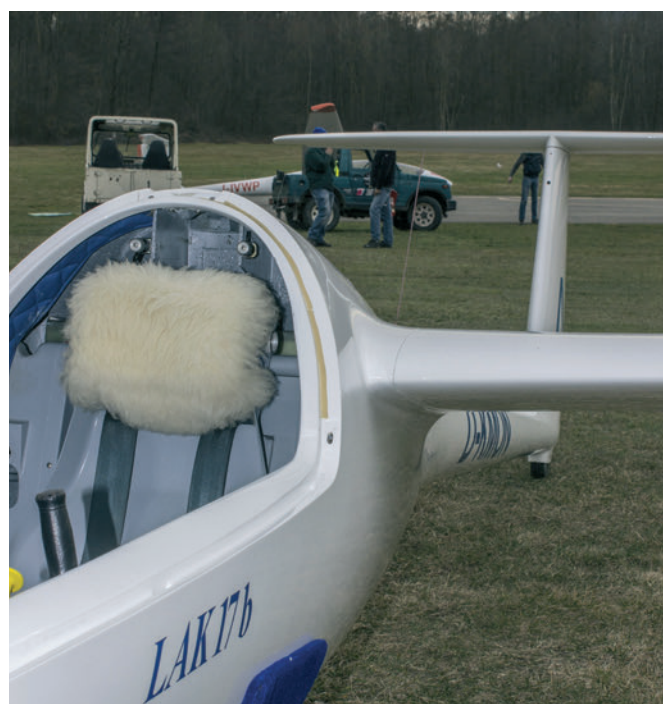
L'ala si inserisce su un raccordo ben sagomato. Il nastro adesivo di sigillatura si applica con facilità
