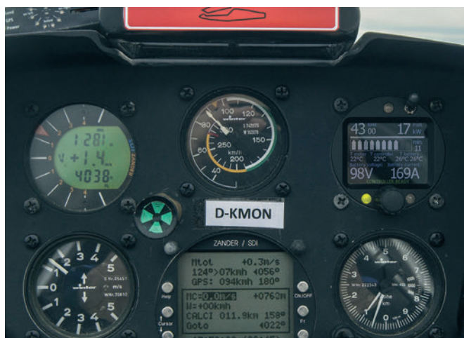
Un dettaglio degli strumenti durante la salita a potenza quasi piena. 1,4 m/s di media
