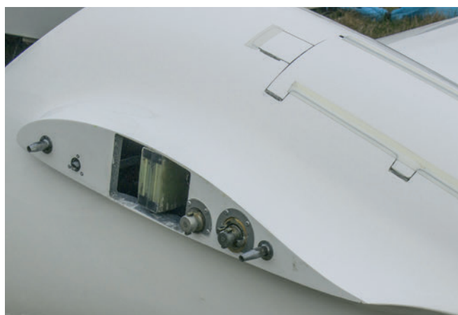
I comandi automatici alla radice alare (si vede il longherone della semiala destra)
