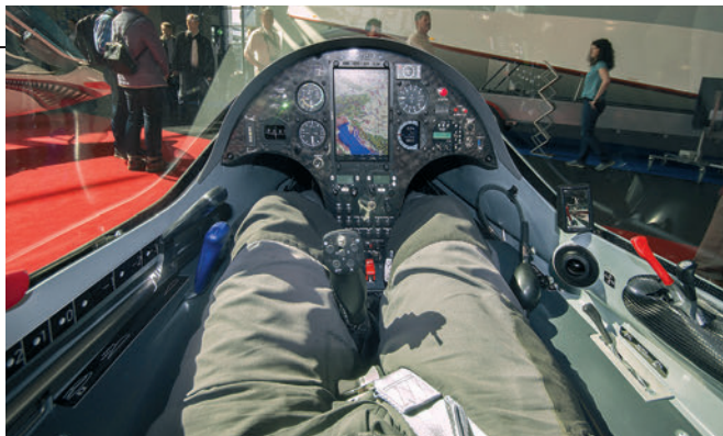
Eccomi nell'ampio posto anteriore del nuovo Twin Shark. Carrello e trim sono a comando elettrico
