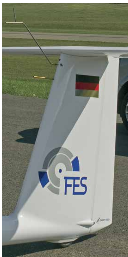
Ruota di coda piccola per una minima resistenza aerodinamica
