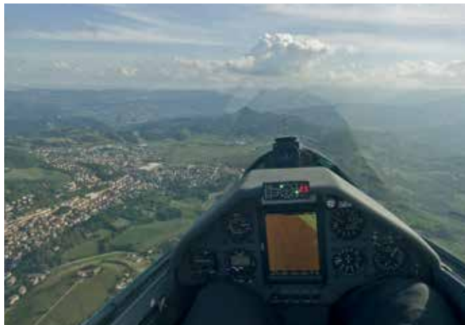
Il display Flarm indica la distanza dal traffico vicino. In prua c'è un piccolo strobo a Led attivabile dal Flarm stesso
