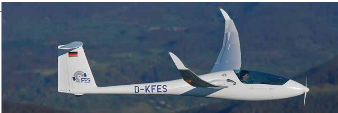
Il Discus 2c FES di base ha le estensioni a 18 metri. Le tip per volare a 15 metri (classe Standard) sono un optional da 8.500 euro
