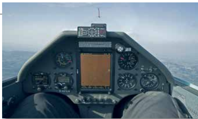
Il cruscotto standard non offre spazio a sufficienza per le ginocchia di piloti di alta statura
