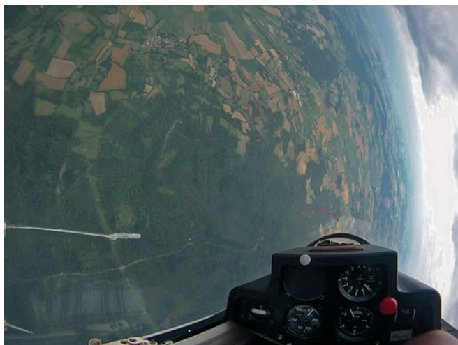
Assetto inclinato a sinistra, con filo di lana che conferma la derapata
