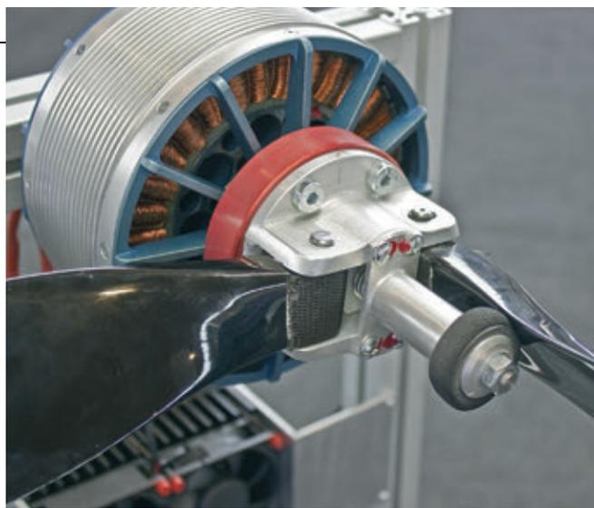
Un motore elettrico con elica ripiegabile
