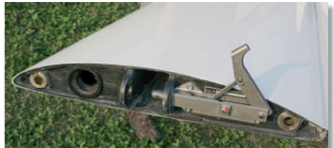
**Rinnovato il sistema di bloccaggio delle prolunghhe, con una bella leva in fusione**
