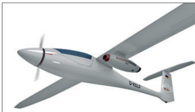
Come già descritto, si tratta di un motoaliente largamente ispirato al noto S10, con apertura ridotta a soli 20 metri anziché 23, e dotato di motore elettrico con elica retrattile nel cono di prua. Ci si attende un'autonomia a potenza ridotta di circa un'ora.
