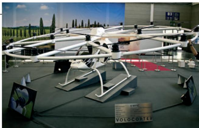
E-volo: un multicottero elettrico con pilotaggio facilitato da giroscopi ed elettronica, si "guida" con una sola mano
