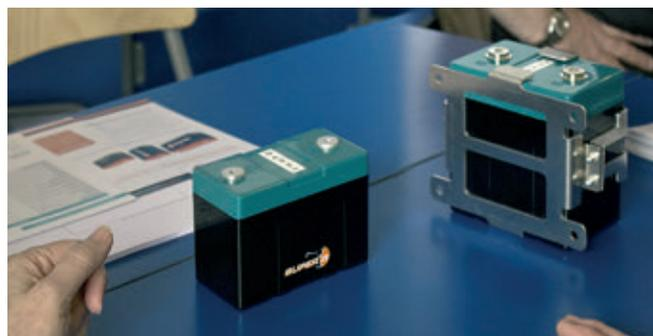
La minibatteria SuperPb (al LiFePO4), per l'avviamento dei Rotax 912
