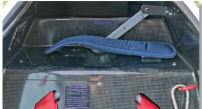
Dietro al sedile, il perno di bloccaggio delle semiali e il piccolo serbatoio carburante
