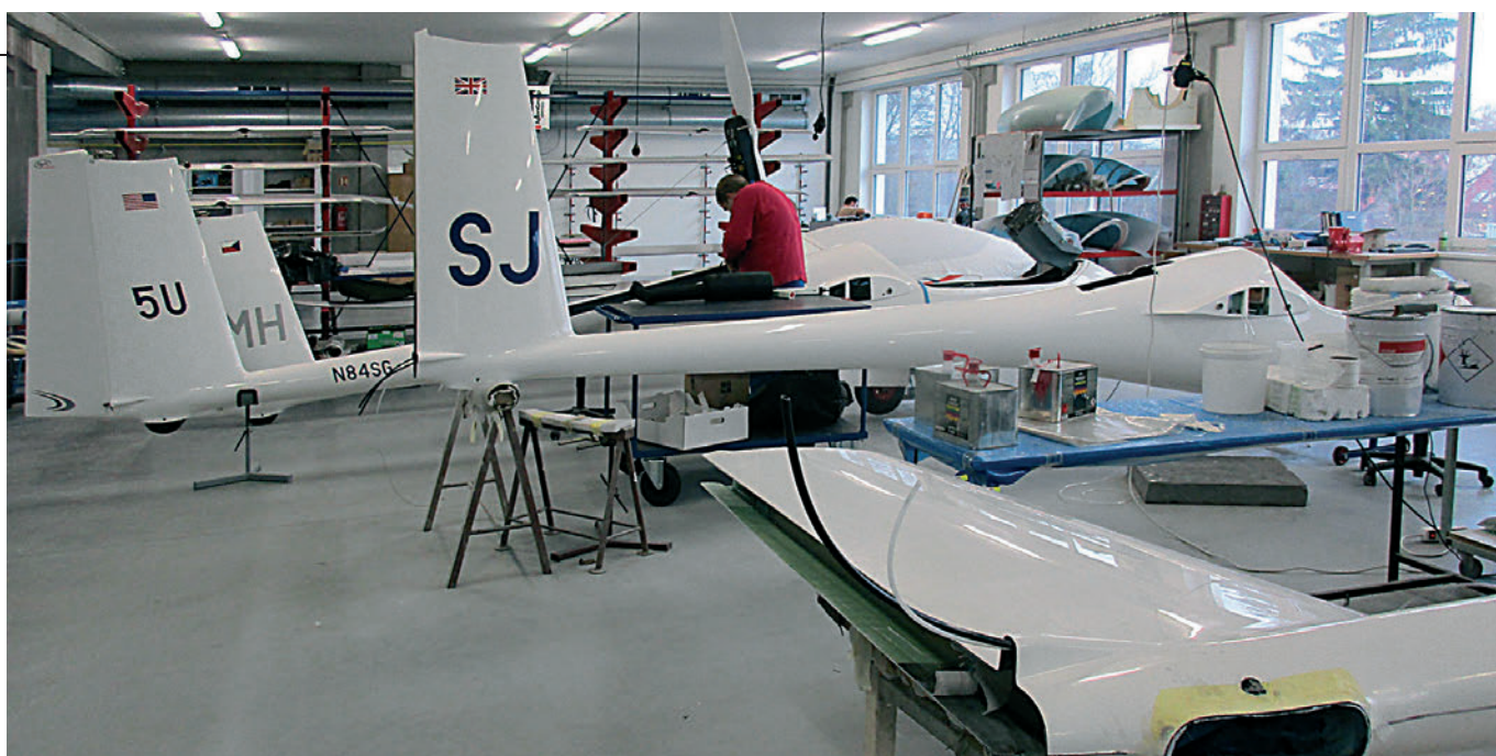
Ali e fusoliere riposano per qualche mese. Si garantisce così la migliore stabilità dei profili...
