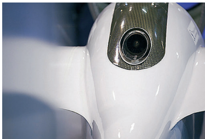
La turbina a getto, fissa nel dorso della fusoliera
