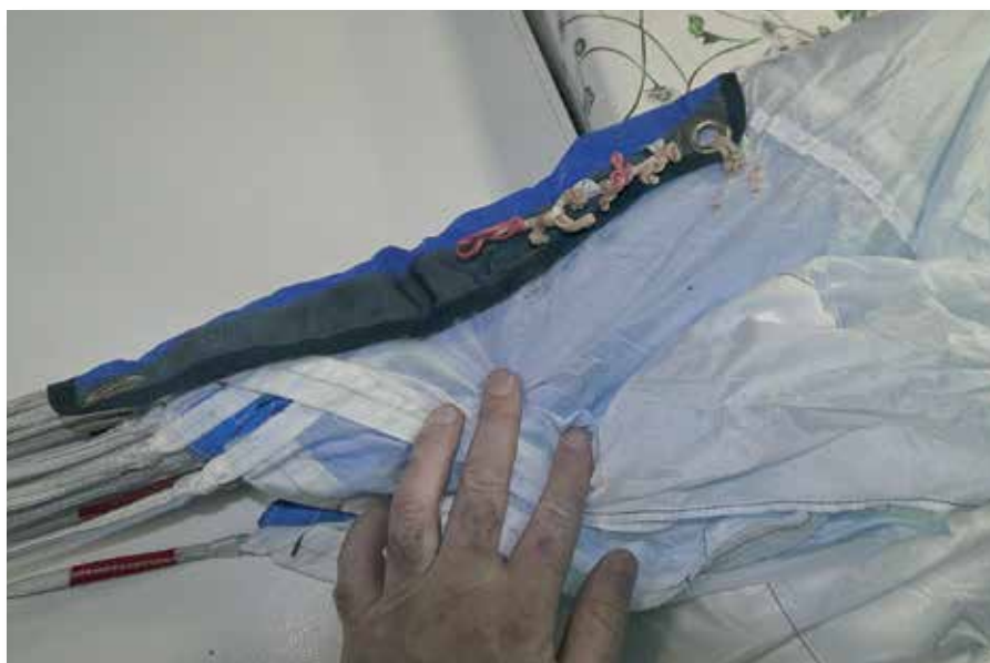
Semplici elastici in lattice mantengono in ordine i fasci di cordini, raccolti in gruppi. Vanno sostituiti regolarmente
