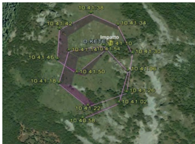
Ricostruzione delle ultime due spirali effettuate dall'aliante
