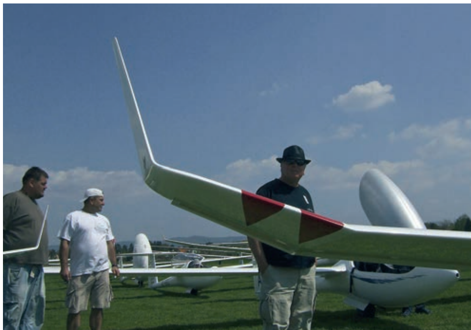
La winglet si innesta su una tip già ben orientata verso l'alto. La velocità oltre la quale è inefficace è calcolata sopra i 220 km/h
