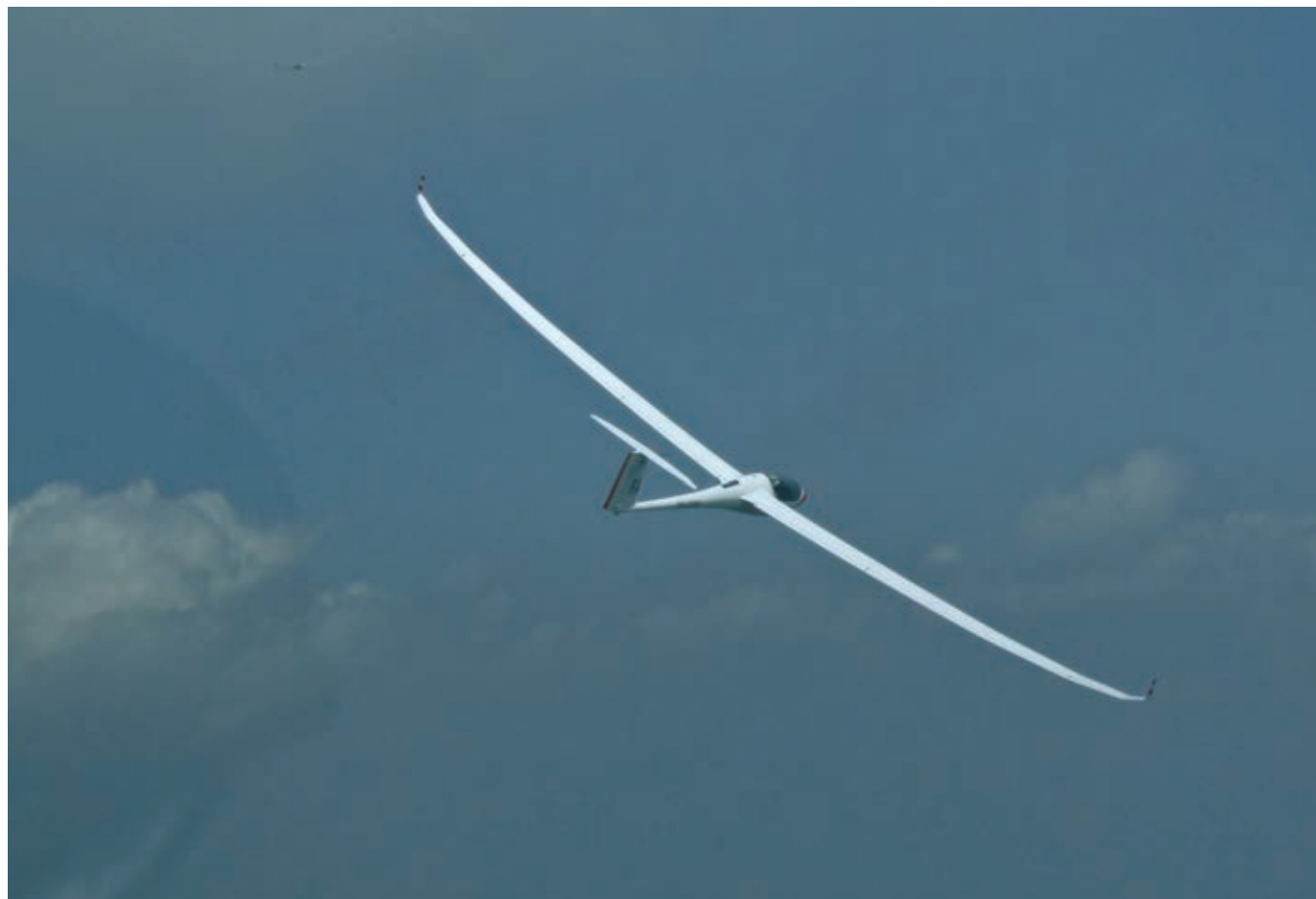
La winglet si innesta su una tip già ben orientata verso l'alto. La velocità oltre la quale è inefficace è calcolata sopra i 220 km/h
