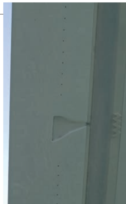
I turbolatori soffianti nel flaperone, con presa Naca e zig-zag
