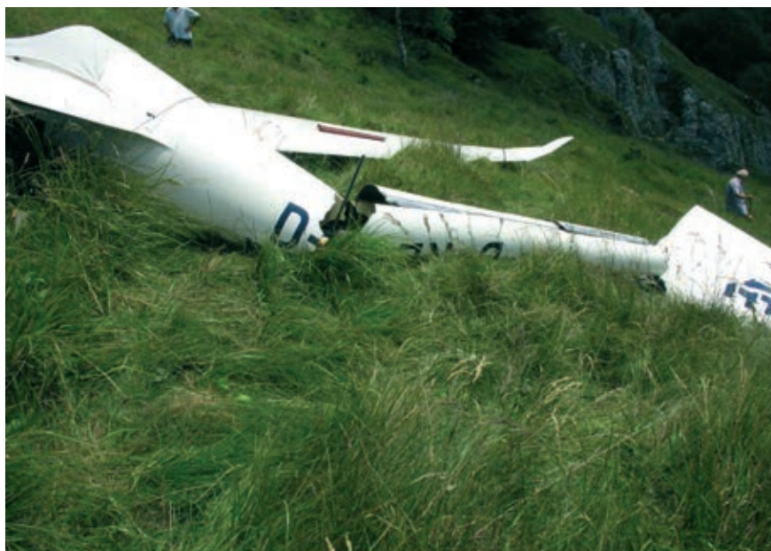
Fusoliera spezzata in tre tronconi
