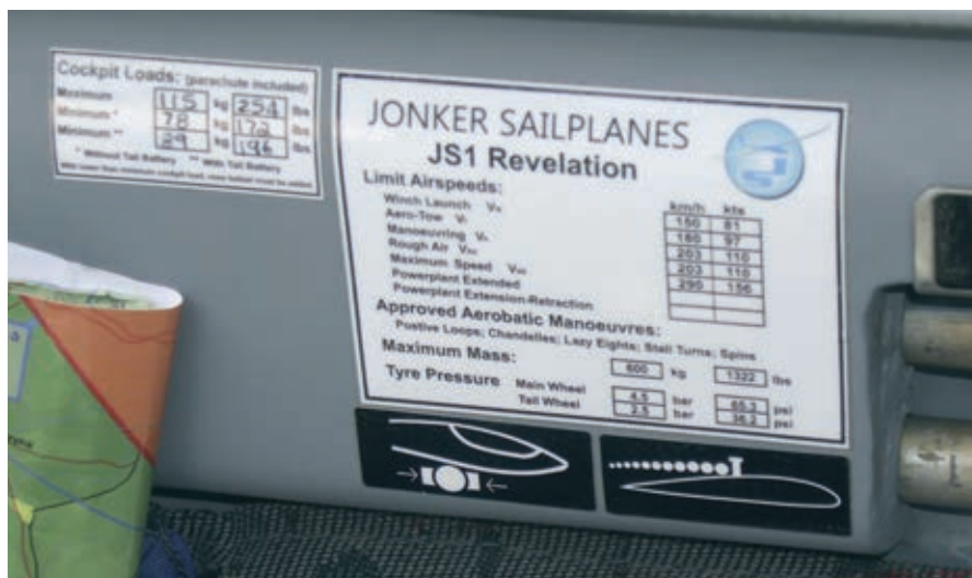
V max in aria turbolenta, 203 km/h. 78 kg il peso minimo in abitacolo, 115 il massimo
