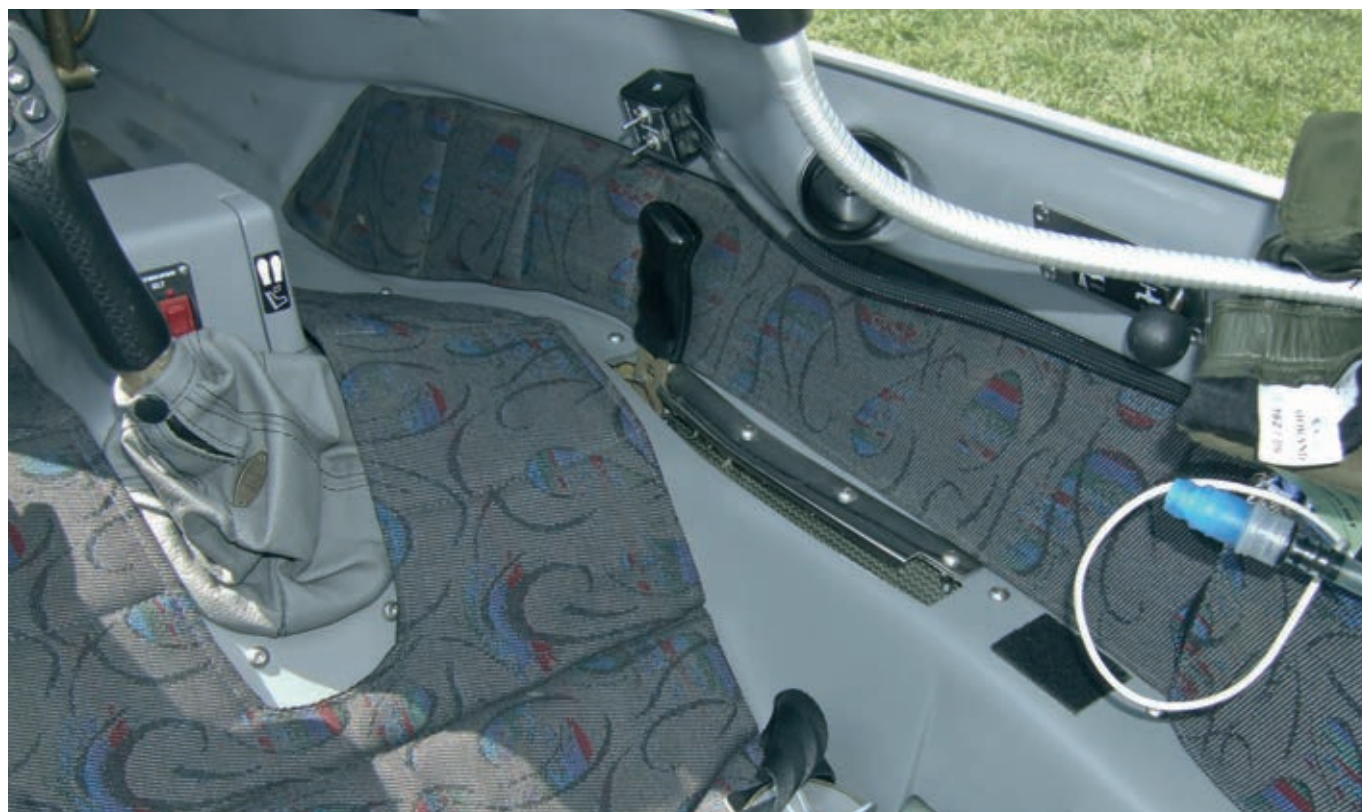
A destra il carrello e gli scarichi della zavorra
