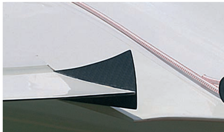
Originali le paratie integrate sugli alettoni, e mobili con essi
