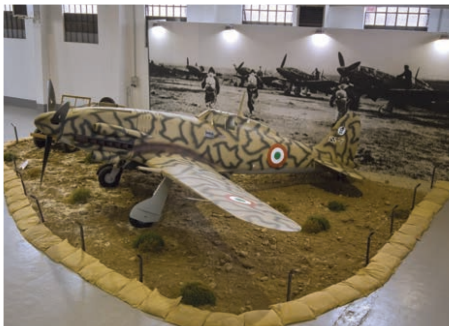
Il C.205V “Veltro” progettato da Mario Castoldi. Struttura metallica, con carrello retrattile ed elica a passo variabile con motore DB605A da 1475 hp, fu il miglior caccia italiano della seconda guerra mondiale
