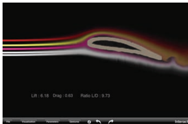
Fig. 1 - Situazione in assenza di ostacoli sotto l'ala: i filetti fluidi scorrono regolarmente
