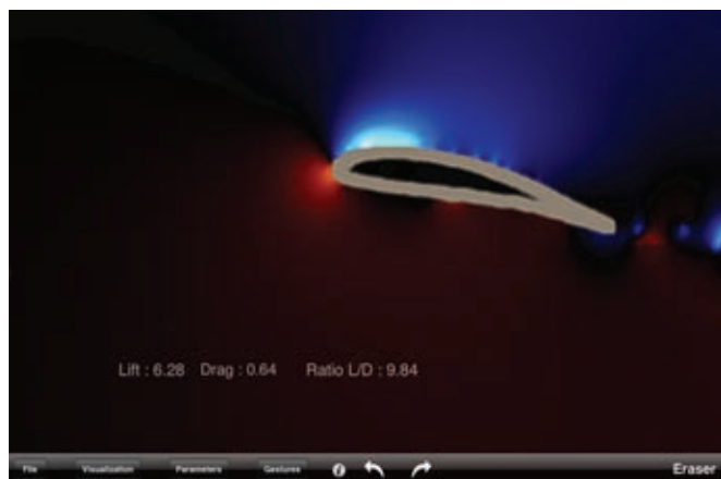
Fig. 3 - Simulazione Senza erba. Pressione in condizioni normali. Colore Rosso = Sovrapressione = pressione superiore alla pressione atmosferica (Punto di Ristagno); Colore Blu = Depressione = pressione inferiore alla pressione atmosferica (Picco di Aspirazione);
