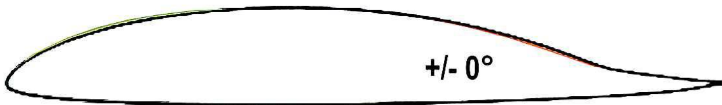
Fig. 9 Anche a Delft è nata una nuova famiglia di profili: la traccia nera rappresenta i classici profili della corrente generazione, mentre i nuovi offrono migliore comportamento agli elevati CL grazie all'accresciuto spessore nella zona che segue il bordo d'attacco, mentre sono leggermente più sottili verso l'uscita
