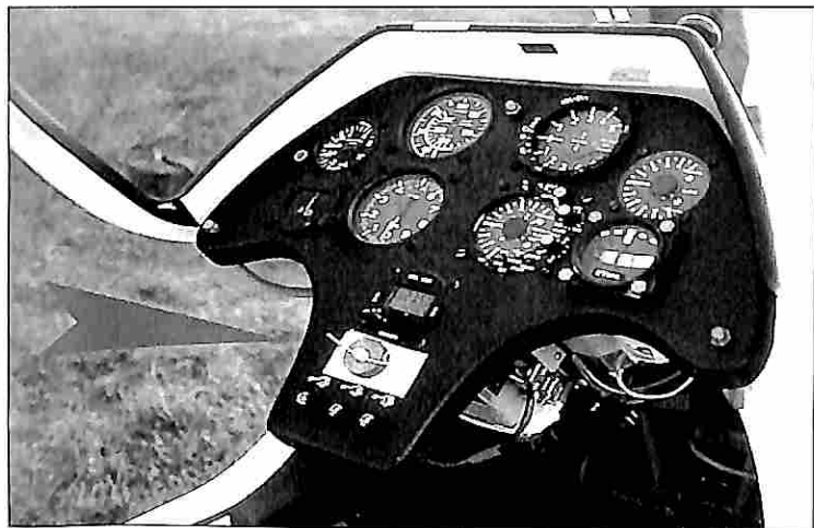
Sul cruscotto dell'ASK-21 viene installato un semplice dispositivo di verifica della presenza di "trudelballast" (zavorra per la vite) in coda
