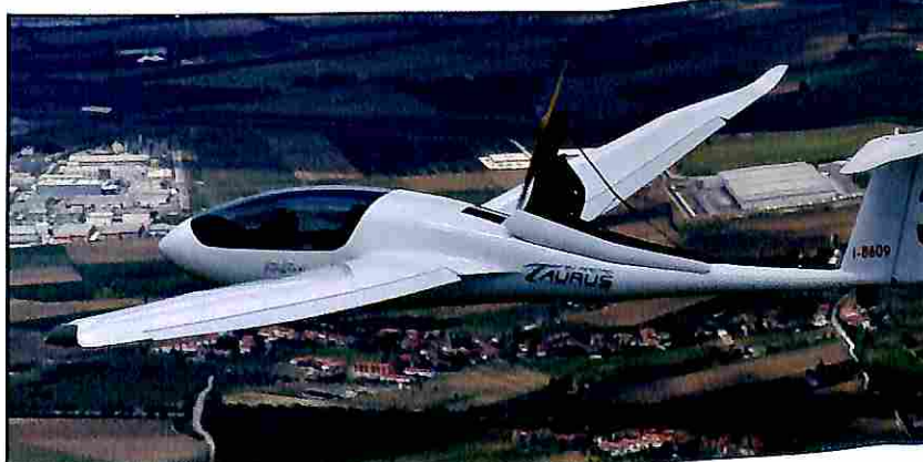
Il Taurus in salita a motore, con flap alla prima tacca positiva
