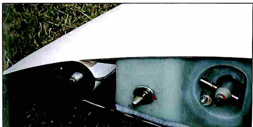
Dettaglio della radice alare con il flaperone (correttamente sigillato) e gli innesti dei comandi
