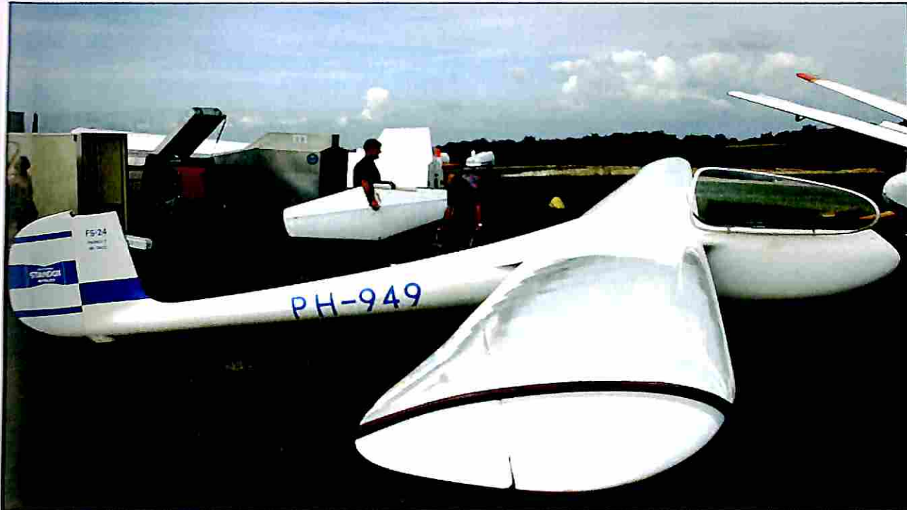
Questo Phoenix FS-24 è forse il primo aliante in compositi della storia
