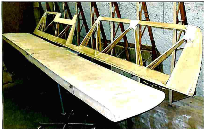
Il piano orizzontale di coda in legno e compensato, restaurato da Werner Roth
