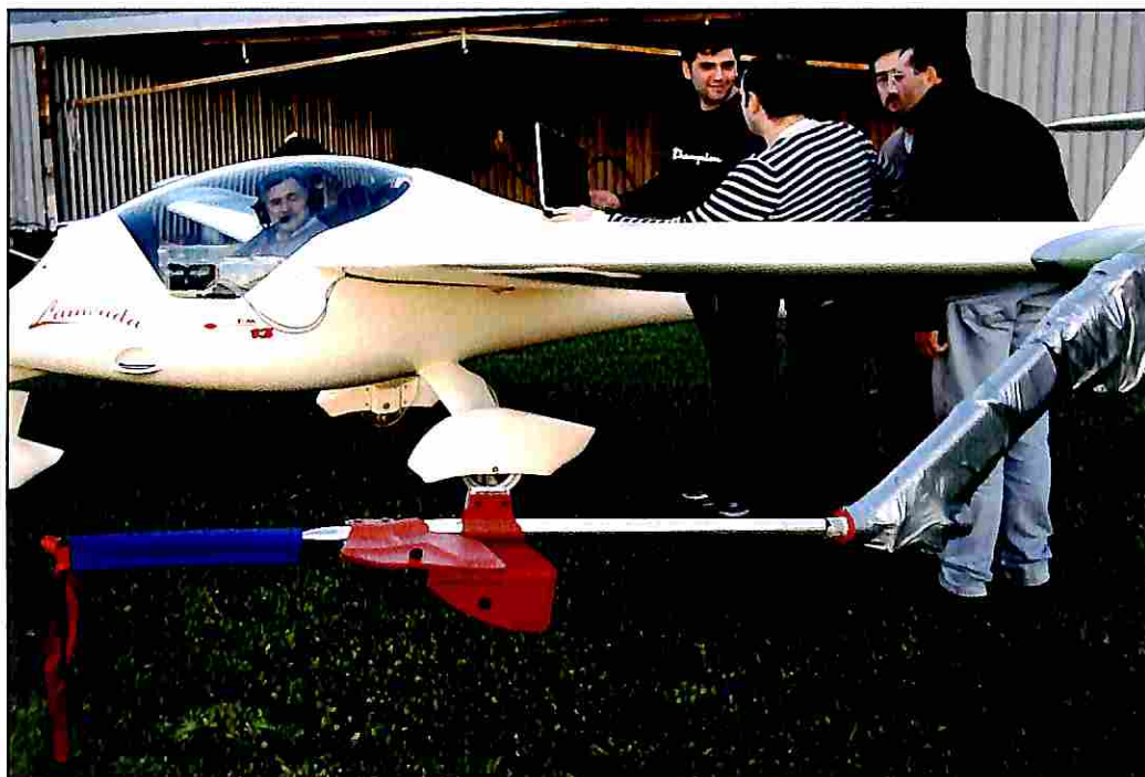
La sonda Air Data con le prese di pressione e le alette che rilevano l'assetto
