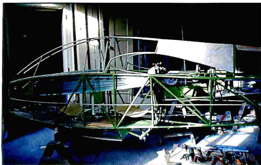
Il traliccio completamente riverniciato, con i nuovi sedili in legno
