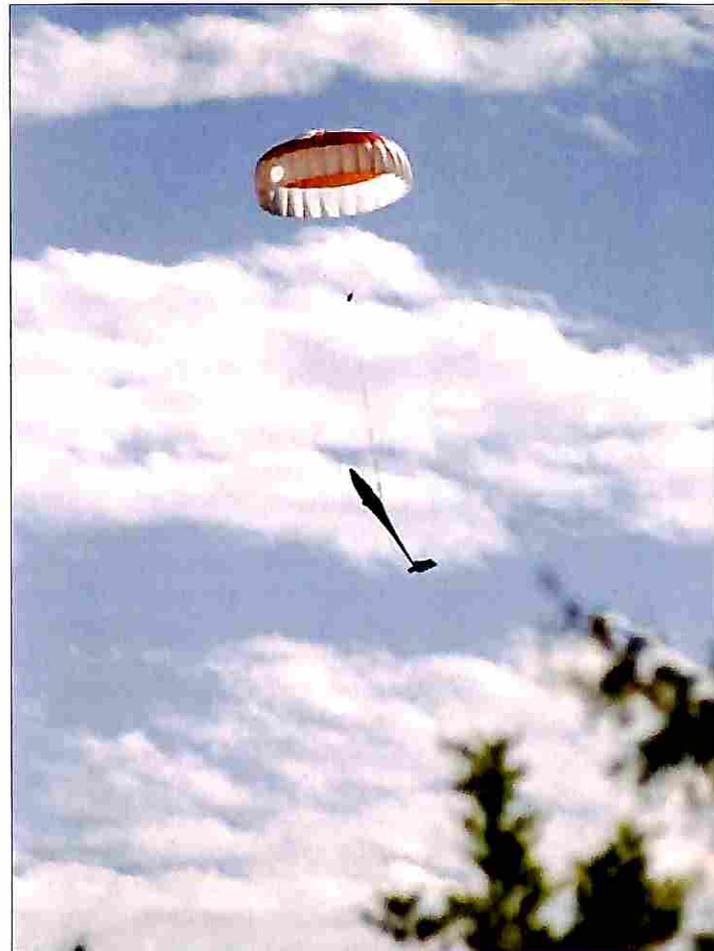
Sparrow Hawk, dotato di paracadute balistico e di un piccolo motore.
