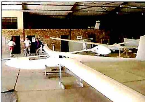
**Formate le ali e la fusoliera negli stampi, si può con soddisfazione procedere a un primo assemblaggio del nuovo aliante**
