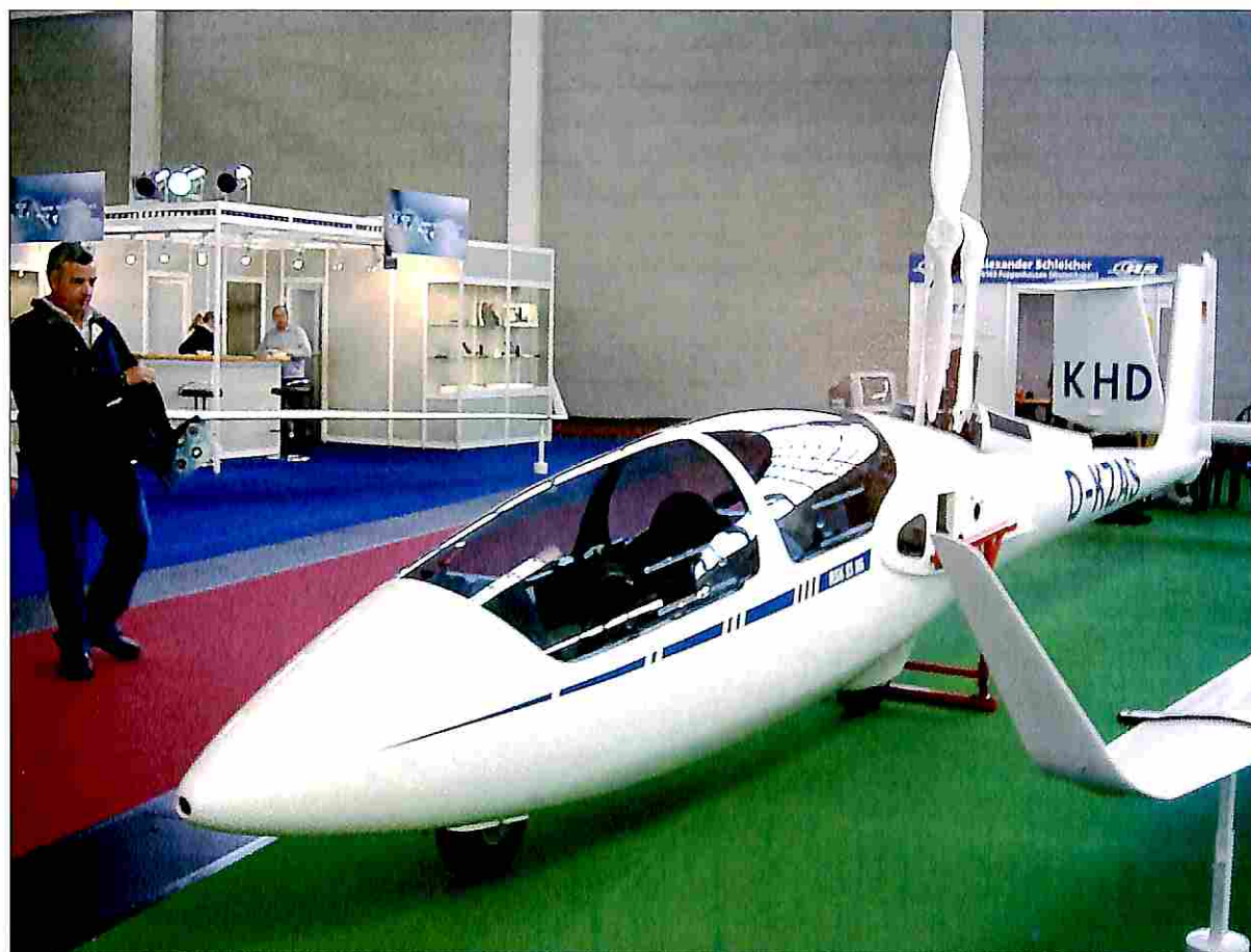
Del nuovo ASK-21 con motore Wankel per il decollo autonomo era esposta la sola fusoliera. Esso apre nuove possibilità per le scuole di pilotaggio
