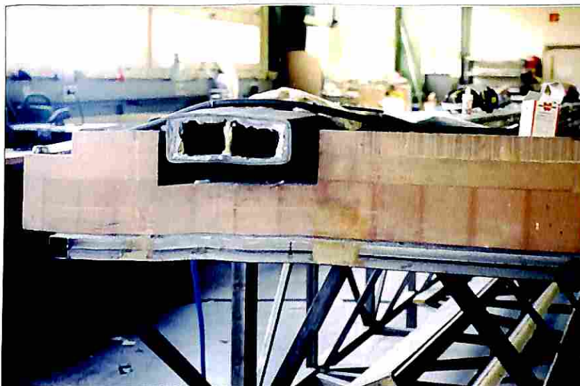
Gli stampi delle ali; la connessione a baionetta
