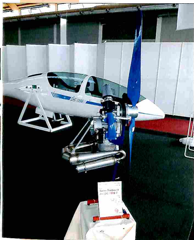
Il motore Goebler-Hirth che verrà installato sul DG-1000 T
