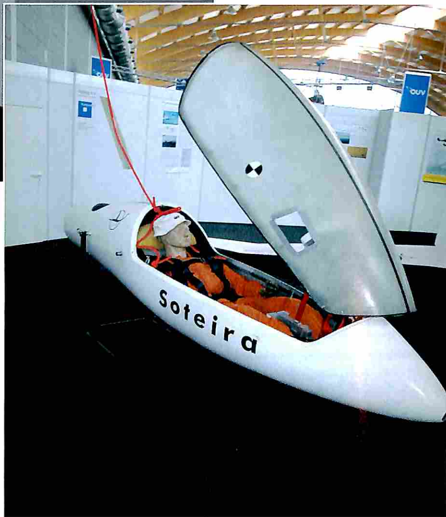
Soteira: il sistema balistico d'emergenza di estrazione del pilota
