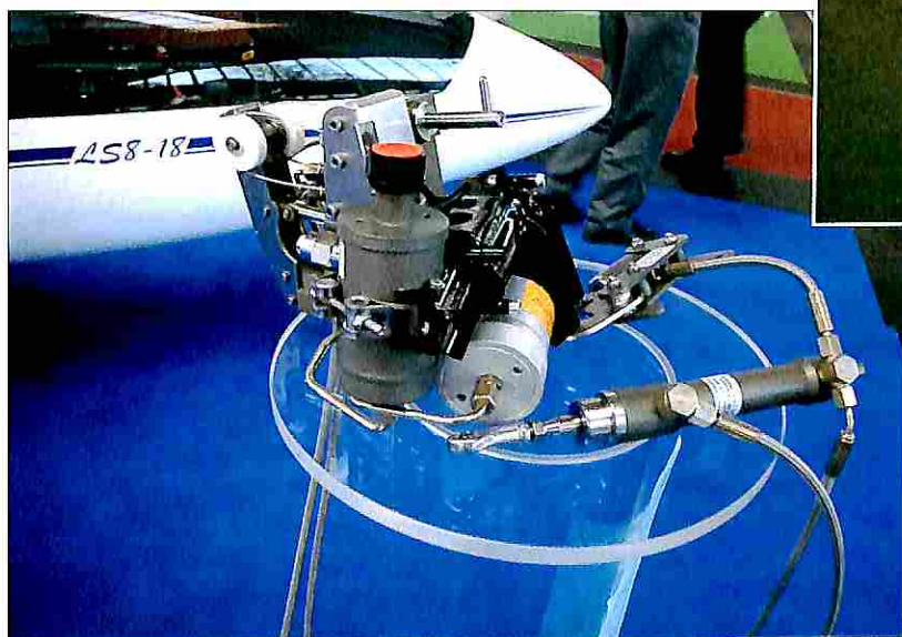
L'impianto pneumatico di estrazione del motore sul nuovo LS-8T
