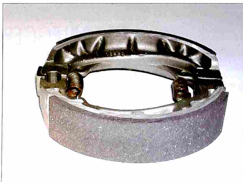
Fig. 7: le stesse ganasce una volta rigenerate con l'applicazione di materiale d'attrito più morbido
