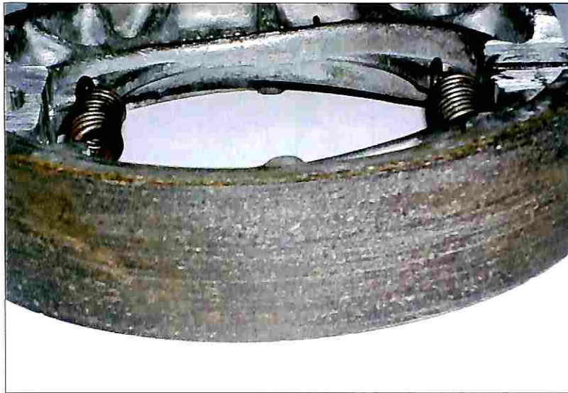
Fig. 3: I materiale d'attrito originale dopo pochissimi utilizzi: la superficie è indurita e "vetrificata", e l'azione frenante ne risulta notevolmente diminuita
