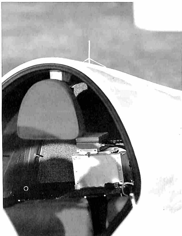
Nel vano posteriore è evidente il contenitore della batteria con applicato il trasmettitore video.
