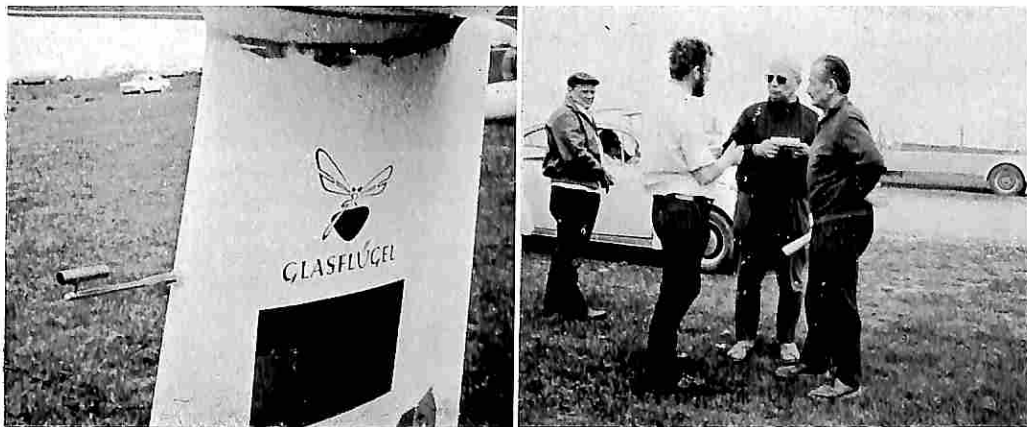
A sinistra: Particolare dell'applicazione del Venturi per il nuovo energia totale; a destra: i dirigenti della competizione
