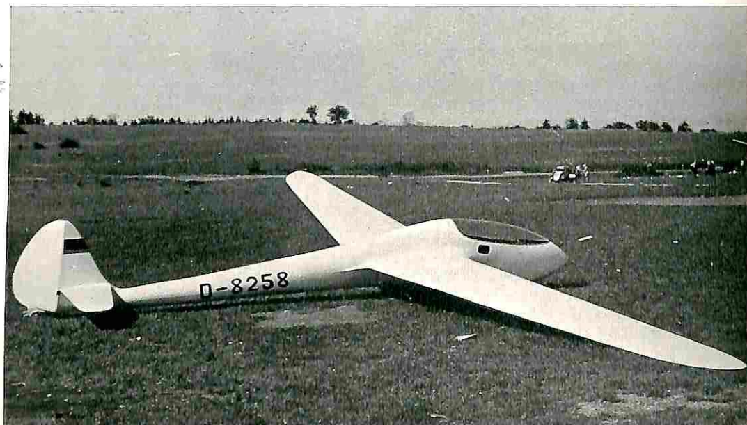
Il Phoenix FS 24 il cui rivestimento è interamente realizzato in vetro-poliestere.
