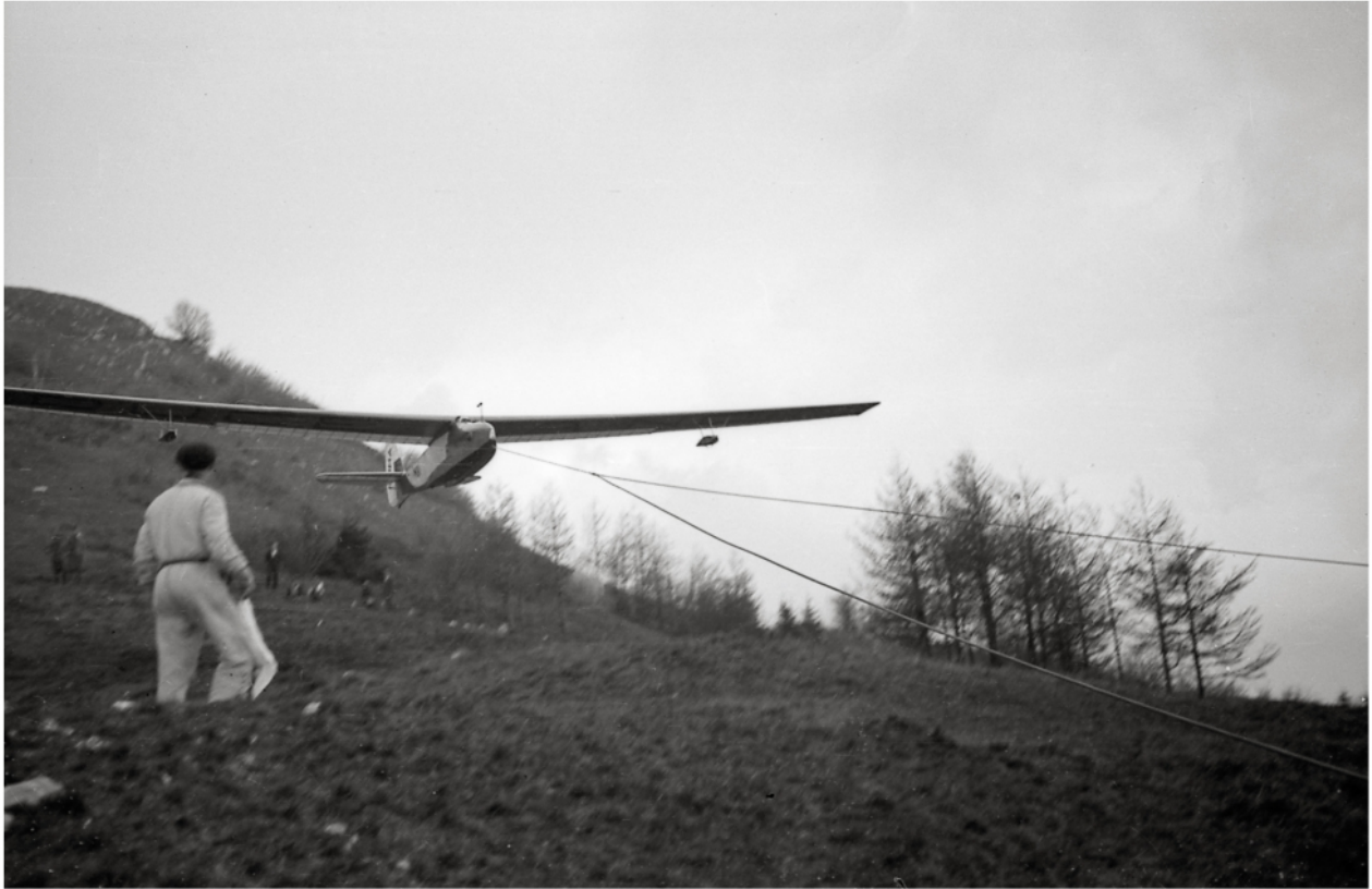
L'aliante "Roma" durante la fase iniziale del decollo con lancio mediante cavi elastici
